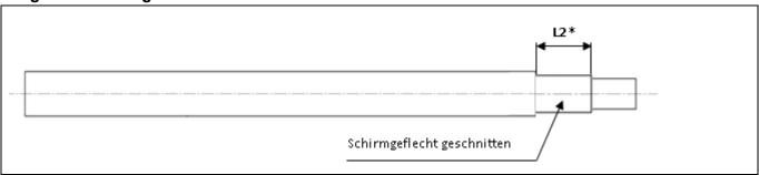
Abhängig von der gewählten Fertigungsmethode des einzelnen Konfektionärs, kann das Maß L2 variieren.
