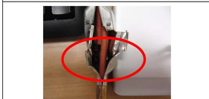
Die Leitungen im Verteiler dürfen nicht geklemmt werden.
