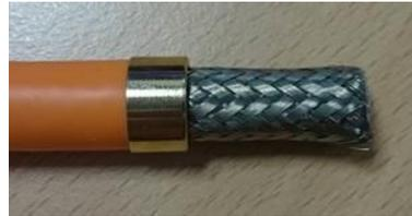
**Bild 30: Folie entfernen**
