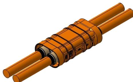
Das Schirmgehäuse ist symmetrisch und kann von jeder Seite aufgeschoben werden. Beim Aufschieben werden Rastlanzen im Schirmblech ausgelenkt und rasten hörbar ein.
